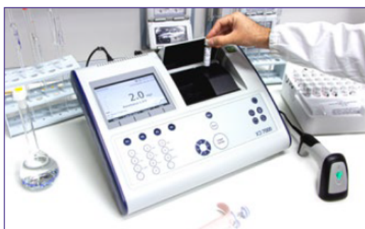
XD 7000 con scanner di codici a barre
