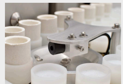
Caricatore automatico con porta crogioli in plastica resistente agli acidi
