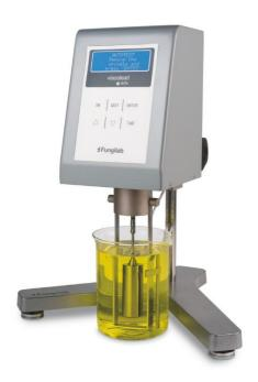
Viscosimetro **rotazionale** professionale Fungilab da laboratorio, per la misura della viscosità di fluidi da **20 cP** a **106.000.000 cP** con **18 velocità** da **0,3 a 100 r.p.m**. Disponibile in 3 versioni L, R e H, a seconda dell'applicazione e al range di utilizzo. Particolarmente indicato per laboratori di QC e/o R&D, con eccellente qualità costruttiva dello strumento e delle giranti tutte in Acciaio Inox **AISI 316.**
