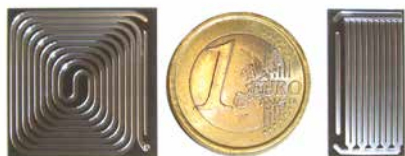
MEMS per preconcentrazione e separazione gas cromatografica
