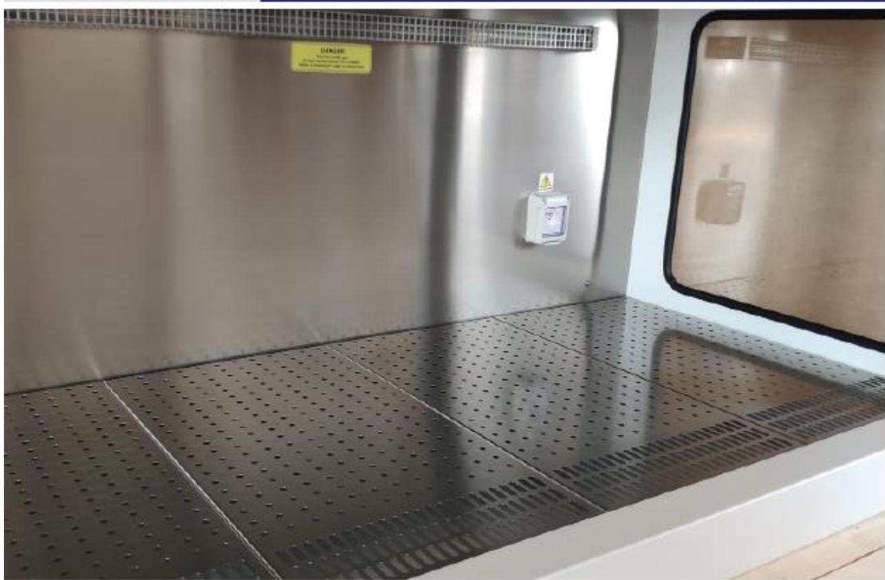
La cappa, caratterizzata da un design moderno ed elegante e da un'elettronica tecnicamente avanzata, è stata studiata per la protezione globale di operatore, prodotto e ambiente e destinata alla manipolazione di microrganismi patogeni a basso rischio biologico.
