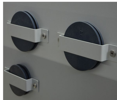
Protezione del foro di accesso in caso di sovrappressione per condizioni di prova stabili
