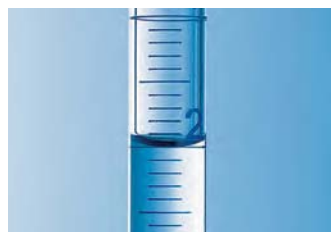
Menisco incurvato verso il basso in una pipetta graduata.
