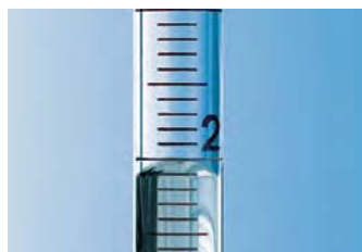
Menisco incurvato verso l'alto in una pipetta graduata.
