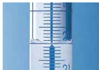
Figura del menisco sulla striscia Schellbach in una buretta.
